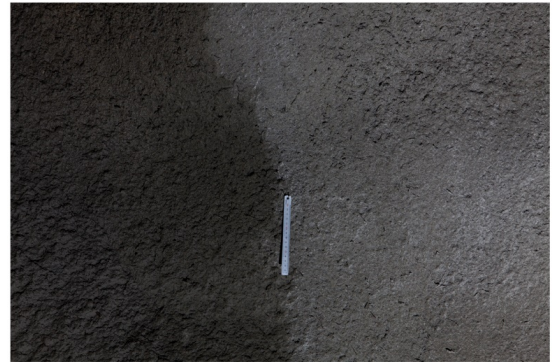
Figur 3.5-3 Fotograferad sprutbetongyta för mätningar av deformationer. Den vänstra halvan av sprutbetongen är blöt och i den högra figuren syns en ställinjal som användes som referens för skala.
