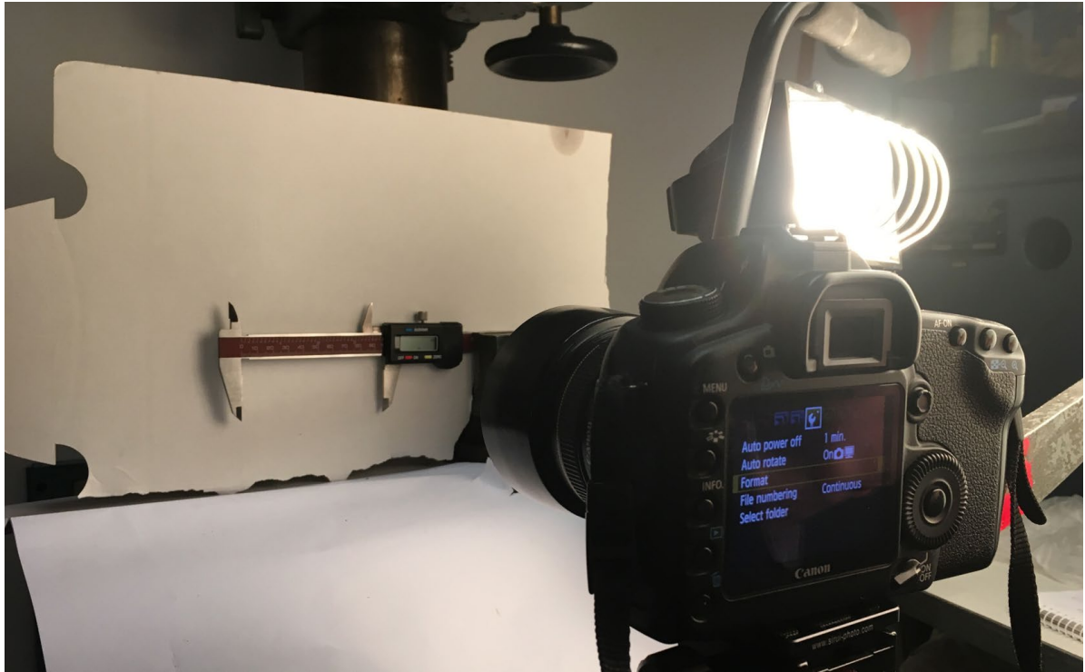
Figur 3.2-1 Uppställning vid labbförsöket med fotogrammetri för att undersöka kamerans kompatibilitet med den egenutvecklade programvaran PY2DIC.
