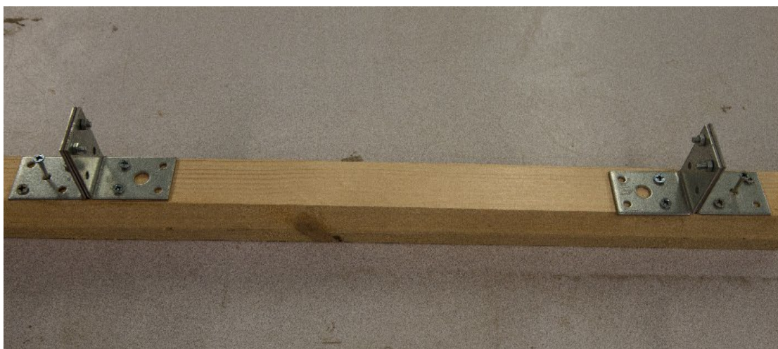
Figur 3.1-2 Försök för att öka repeterbarheten vid mätningar med mikrometer där vinkeljärn i stål användes i kombination med stålplåtar försedda med hål för att öka styvheten och guida mikrometerskruven till samma ställe vid upprepade mätningar.
