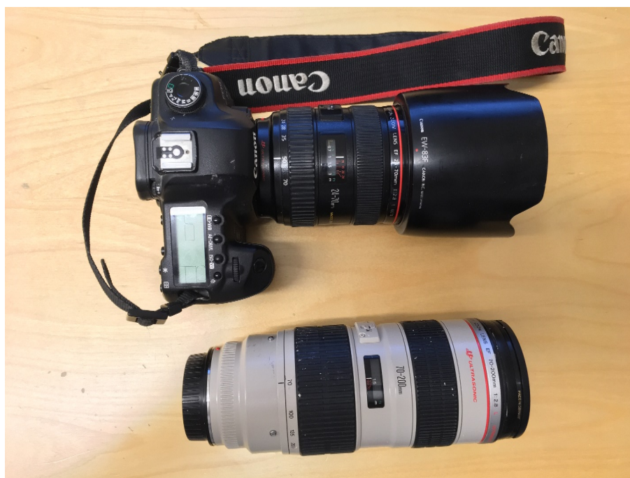
Figur 2.5-2 Använd kamerautrustning för fotogrammetri.
