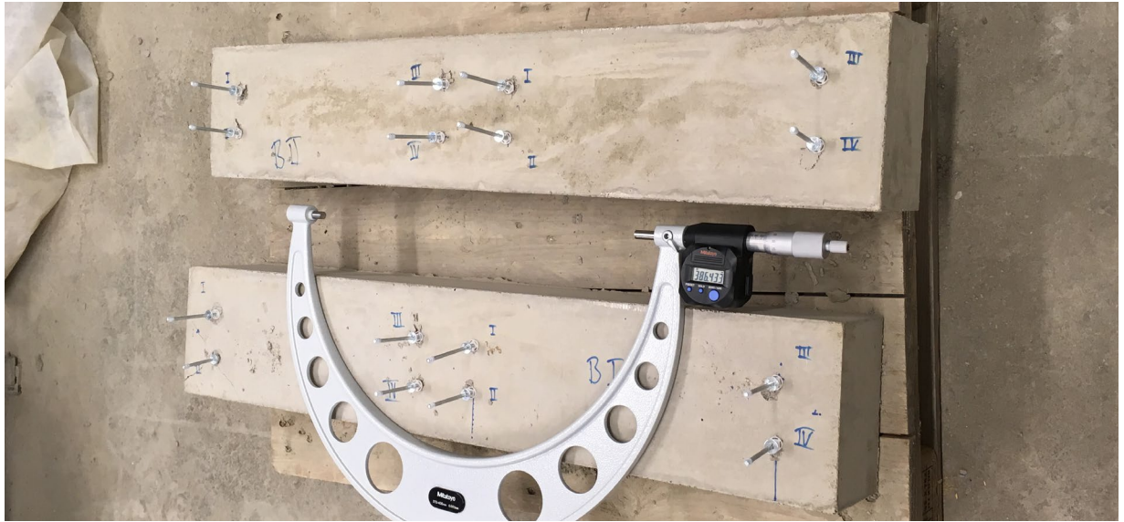
Figur 3.1-1 Spikar fastsatta i betong för att kunna mäta relativa rörelser.
