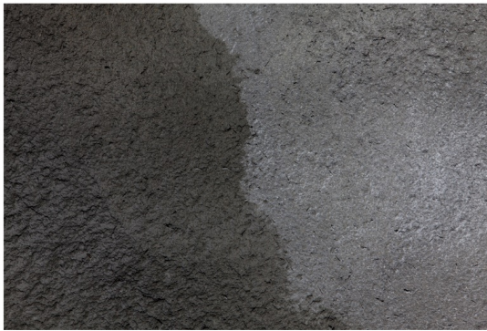
Figur 3.5-3 Fotograferad sprutbetongyta för mätningar av deformationer. Den vänstra halvan av sprutbetongen är blöt och i den högra figuren syns en ställinjal som användes som referens för skala.
